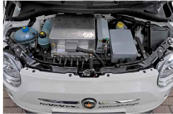
Abbildung 2: Dort, wo sonst ein Verbrennungsmotor sitzt, wird ein Elektromotor eingebaut. Ausgeklügeltes Batteriemangement sorgt für hohe Reichweiten.
