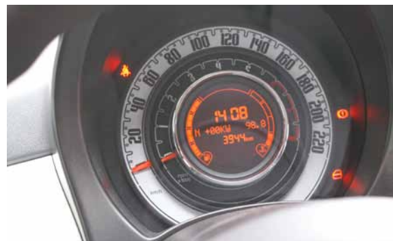
Abbildung 3: Die Tankanzeige: Mit Hilfe des Wachendorff-Wandlers zeigt diese nun den Ladezustand der Akkus an.
