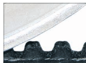
Spezialzahnriemen für sehr leises und schlupffreies Messen.
