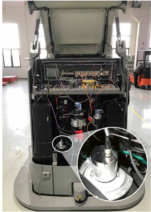
Abbildung 3: Drehgeber WDGA 58E zur Erfassung des Drehwinkels des Lenkmotors.
