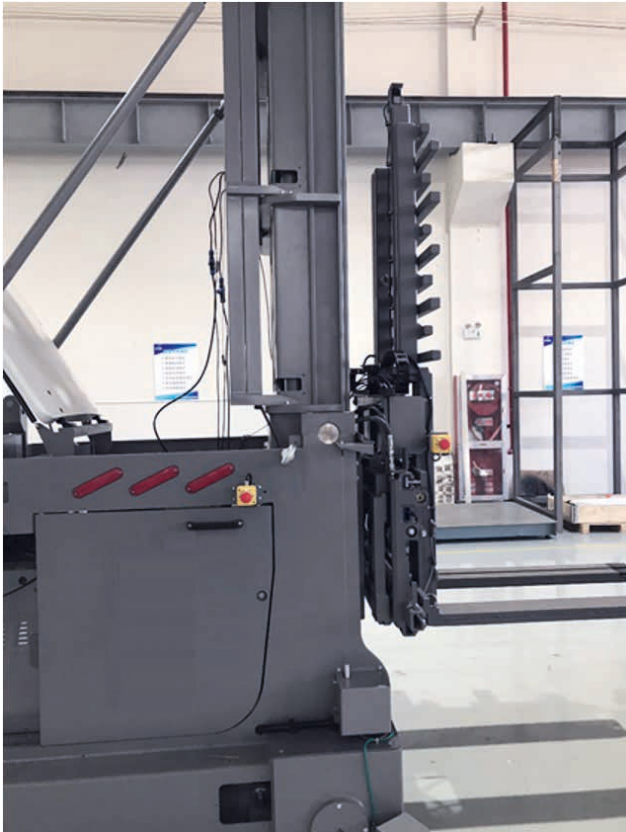
Abbildung 1: Seilzugsystem SZG165 zur genauen Positionierung.
