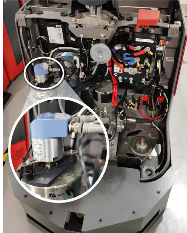
Abbildung 2: Redundanter Drehgeber WDGR 58B zur Erfassung der Geschwindigkeit.
