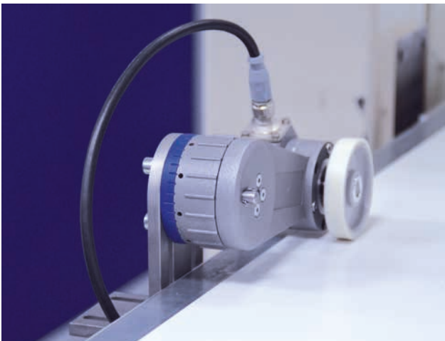
Abbildung WA1601_2 Hier erkennt man gut das Einstellrad mit seinen Rasterungen, über welches ganz komfortabel der Anpressdruck zwischen 5 und 30 N variiert werden kann.
