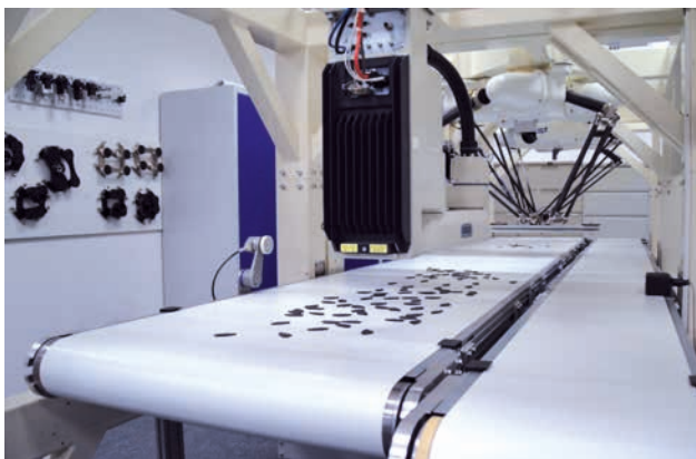
Abbildung WA1601_1a und WA1601_1b Adept Quattro wurde speziell für High Speed-Anwendungen im Handling entwickelt. Hier kommt es auf besonders präzise Messwerte an – und die liefert das Längenmesssystem LMSMA2x/3x aus dem Hause Wachendorff Automation
