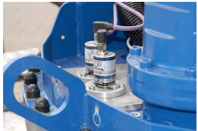
Abbildung 4 Absolute Drehgeber WDGA von Wachendorff erfassen die Drehung des Auslegers um die eigene Achse. Aus Sicherheitsgründen ist das gesamte Sicherheitssystem mit Sensorik und Steuerungen redundant ausgelegt – darum zwei Geber nebeneinander, die jeweils völlig autark arbeiten. Durch die EnDra®-Multiturn-Technologie arbeiten die Geber batterieless und verschleißfrei.
