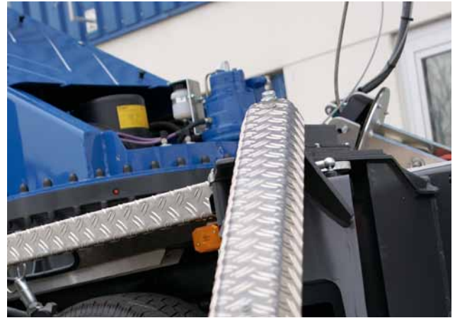
Abbildung 3 Die Stützen können stufenlos ausgefahren werden. So passt der Kran auch in schmale Straßen oder Baulücken.
