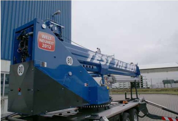
Abbildung 6 Der Mast wirkt beim Transport klein und kompakt – Arbeitshöhen von 40 Metern und Reichweiten von 30 Metern sind damit aber problemlos möglich.
