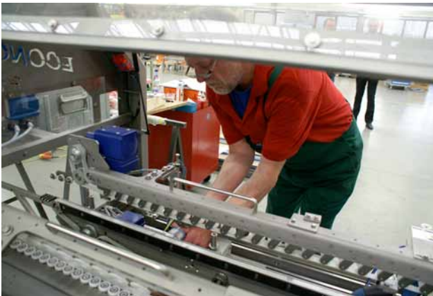
Abbildung 9 Ullrich Dettweiler montiert einen Drehgeber von Wachendorff. Der hier eingesetzte Typ ist mit Impulszahlen von 2 bis 25000 erhältlich. Der Kunde kann außerdem zwischen verschiedenen Auflösungen, Ausgangsschaltungen und Steckern wählen.
