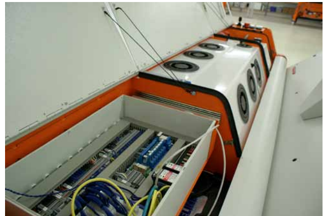
Abbildung 1 Viel Technik im Inneren: Im Vordergrund die Steuerung, dahinter die Tanks für Frischwasser, Reinigungs- und Pflegemittel.
