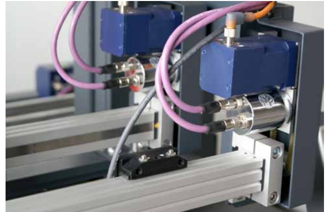
Abbildung 5 Bei dieser BST-Lösung kommen sechs Drehgeber zum Einsatz. Für jede Bahn gibt es ein Sensorenpaar, das die Position erfasst und über die CANopen-Schnittstelle kommuniziert.
