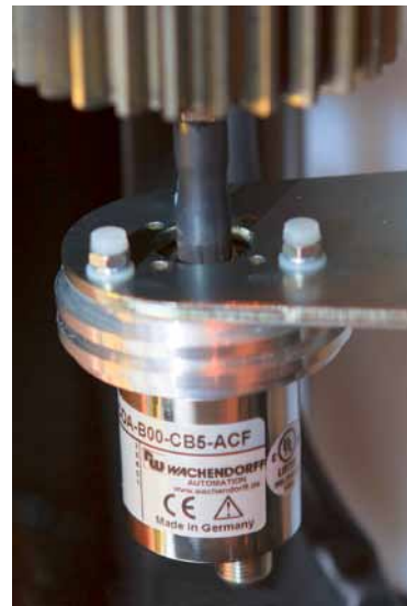
Abbildung 4 Die Voraussetzung für automatisierte Abläufe sind Sensoren. Im Bild: Absoluter Drehgeber WDGA mit EnDra®-Multiturn-Technologie von Wachendorff.
