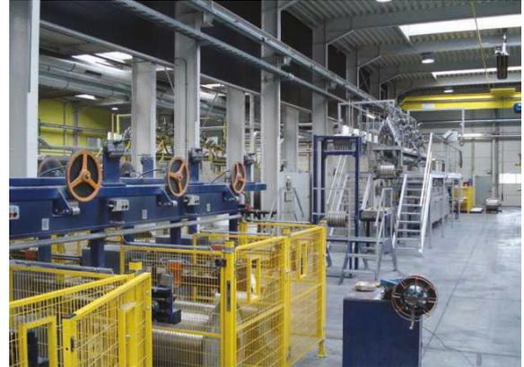
Abbildung 9 und 10: Der Draht wird, nachdem er die Glühanlage passiert hat, wieder auf Spulen aufgewickelt und weiter bearbeitet.
