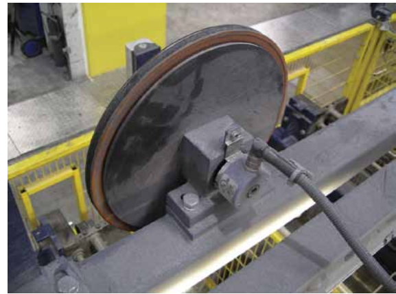
Abbildung 4 und 5: Da die Drehgeber völlig offen angebracht sind, müssen sie besonders unempfindlich sein. Kein Problem für Wachendorff-Geräte, die außergewöhnlich robust sind.
