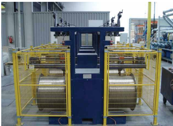
Abbildung 8: Drehgeber von Wachendorff messen die exakte Bahngeschwindigkeit und regeln so über die Steuerung den Antrieb des Motors.
