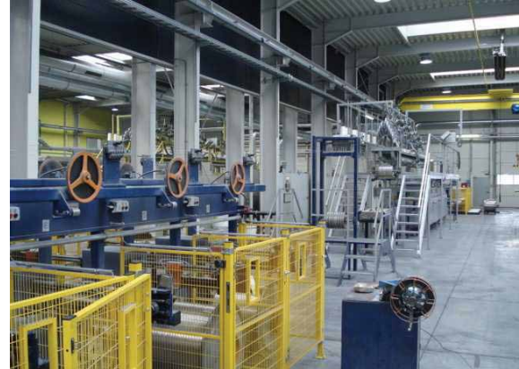
Abbildung 9 und 10: Der Draht wird, nachdem er die Gluhanlage passiert hat, wieder auf Spulen aufgewickelt und weiter bearbeitet.
