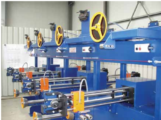
Abbildung 1 bis 3: Auf dieser Anlage von Kistner wird in Österreich Schweißdraht hergestellt.
