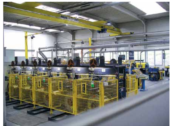
Abbildung 11: Maschinelles Drahtziehen ist ohne leistungsfähige Regelungstechnik nicht zu realisieren.
