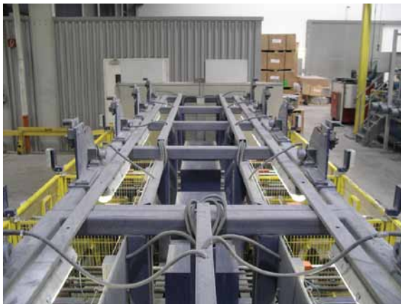
Abbildung 8: Drehgeber von Wachendorff messen die exakte Bahngeschwindigkeit und regeln so über die Steuerung den Antrieb des Motors.
