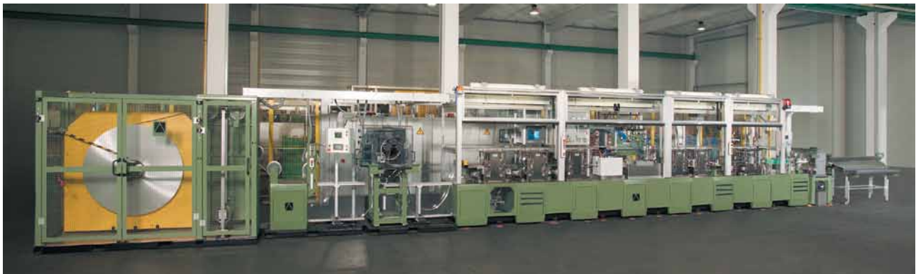
Abbildung 2 Gesamtansicht (Schöler): So sieht eine Anlage zur Fertigung von Rohren aus – vorne läuft das Metallband hinein – hinten fallen die fertigen Rohrabschnitte heraus.
