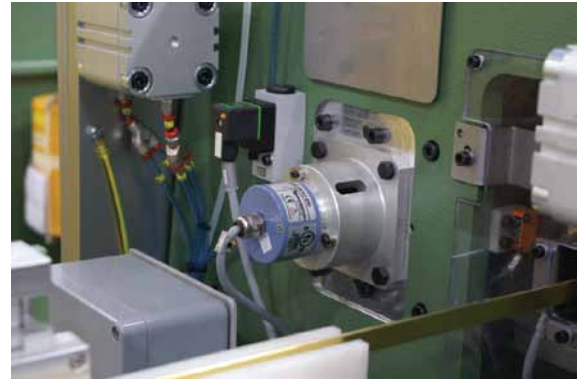
Abbildung 3 Drehgeber Arm (Wachendorff): Dieser Drehgeber erfasst die Drehgeschwindigkeit und damit die exakte Position des rotierenden Arms und gibt diese Messwerte an die Steuerung weiter.
