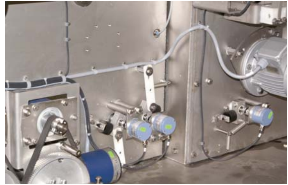
Abbildung 4 Ein Rad, das über einen Federarm gelagert ist, misst die Länge jedes einzelnen Fisches mit Hilfe eines Drehgebers von Wachendorff und gibt die Werte an die Steuerung der Schnittmotoren weiter.
