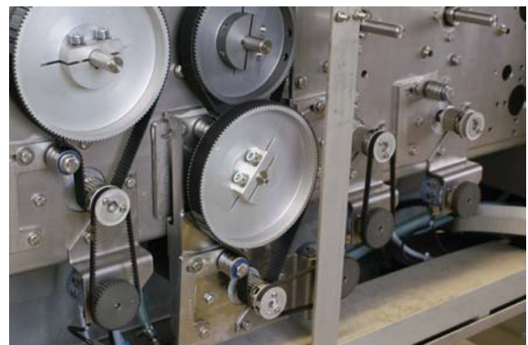
Abbildung 6 Drehgeber von Wachendorff registrieren millimetergenau den Weg, den die Fische in der Maschine zurücklegen.
