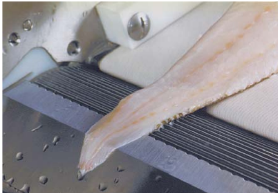
Abbildung 2 Hier wird die Haut entfernt.
