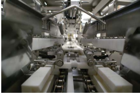
Abbildung 7 Ein Blick in das Innere einer Maschine: Am Anfang steht die Messung der Länge – im Hintergrund warten dann die Messer darauf, Kopf, Flossen, Haut und Gräten zu entfernen.
