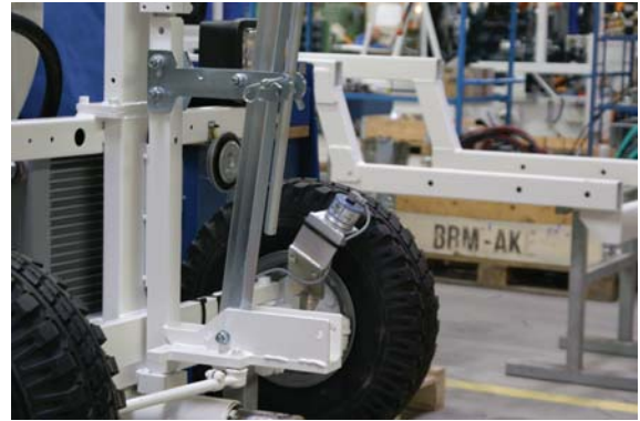
Abbildung 2 Einsatz des Drehgebers WDG 58 am Vorderrad
