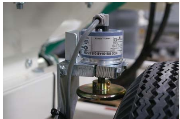
Abbildung 4 Stoß- und vibrationsfeste Montage. Nahezu schlupffreie Messung über ein spezielles Messrad
