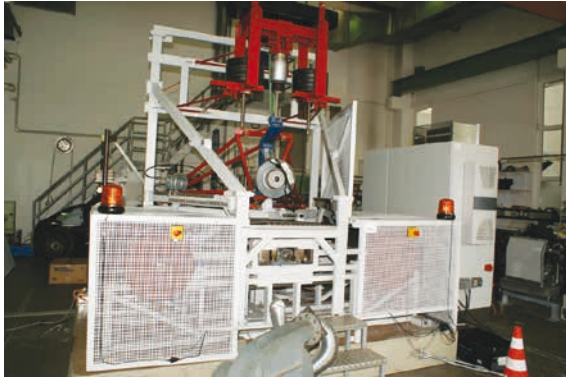
Abbildung 1 Der von Prof. Tiemann entwickelte Viertelfahrzeugprüfstand ist derzeit der einzige weltweit.
