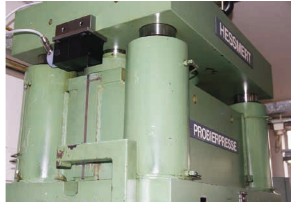
Abbildung 5 Betagte Hydraulikpresse mit modernster Steuerungstechnik nachgerüstet.
