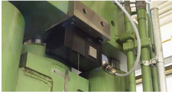
Abbildung 3 Die Drehgeber geben Signale zur Seilmenge aus, somit kann die Steuerungssoftware die Lage der Presse genauer beeinflussen.
