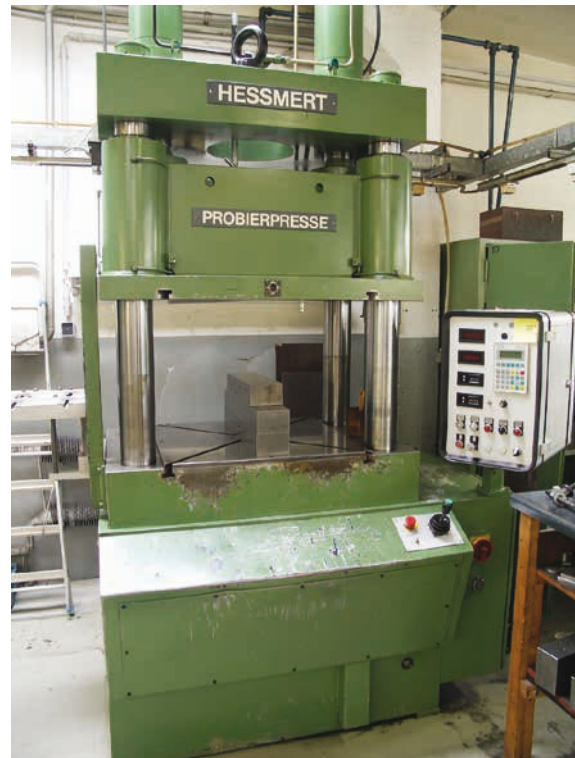
Abbildung 1 Die modernisierte Probierpresse, mit der die Werkzeuge geprüft werden.
