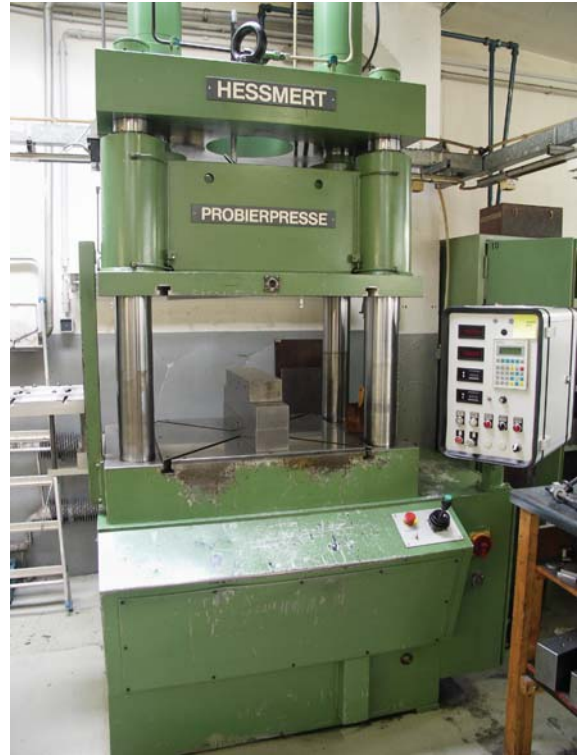
Abbildung 1 Die modernisierte Probierpresse, mit der die Werkzeuge geprüft werden.
