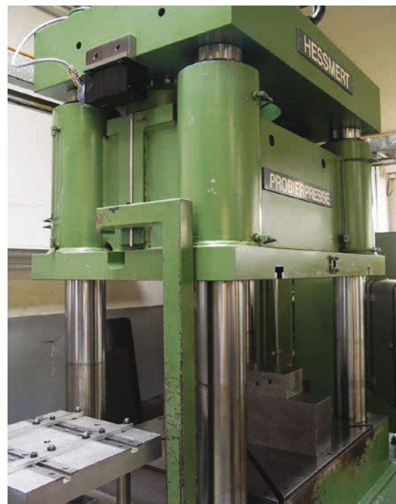
Abbildung 2 Ein Seilzugsystem mit Drehgeber an jedem Hydraulikstempel erlaubt eine genaue Bestimmung der Lage
