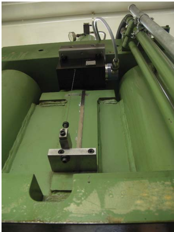
Abbildung 4 Der SZG81 seitlich an der Presse montiert.
