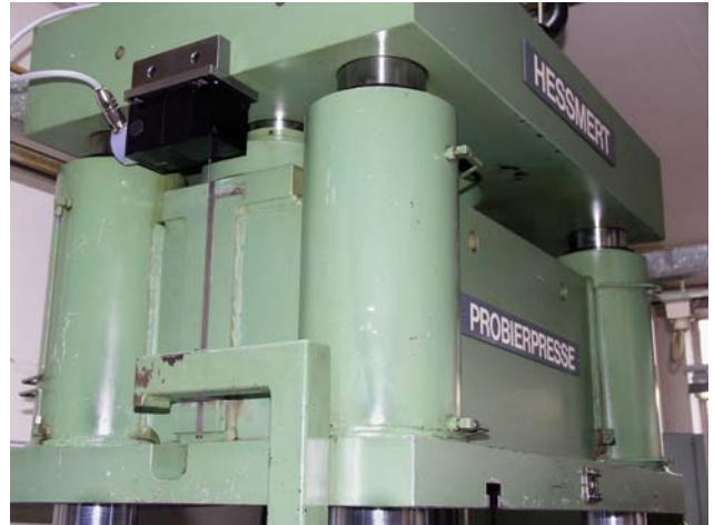
Abbildung 5 Betagte Hydraulikpresse mit modernster Steuerungstechnik nachgerüstet.
