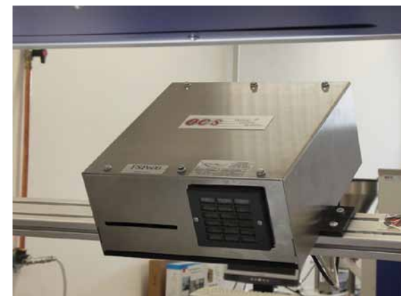
Abb. 3 In diesem Gehäuse befindet sich die Zeilenkamera und die Elektronik
