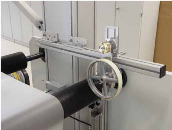
Abb. 4 - Der Drehgeber kann mit dem Federarm einfach angebracht werden
