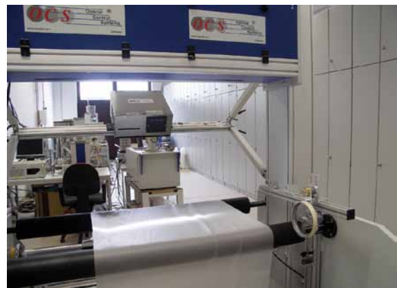
Abb. 2 Bei transparenter Bahnware wird mit Durchlicht gearbeitet
