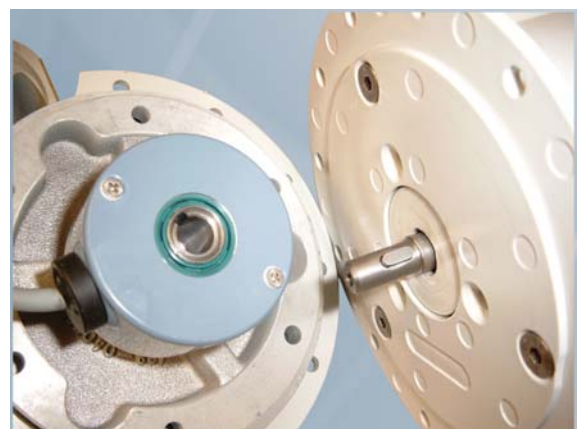
Abbildung 4 Die Hohlwelle des Gebers. Passend für die Aufnahme der Welle mit Feder
