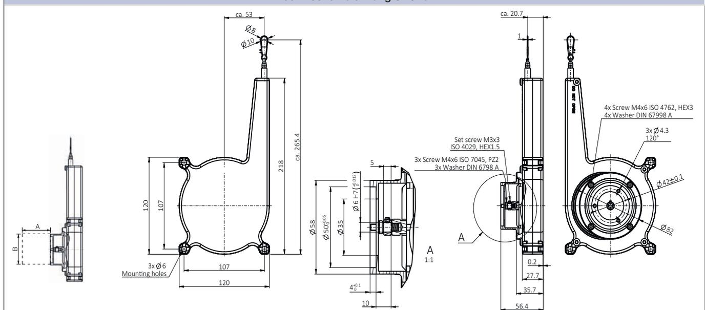
A, B = Maße bitte aus dem Datenblatt des eingesetzten Drehgebers entnehmen.
