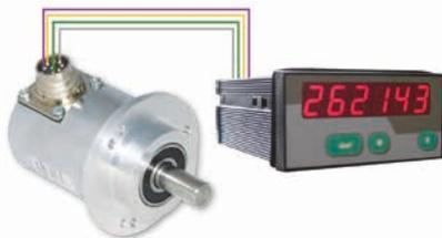
Die Schnittstelle liefert für die Auswertung den vollständigen Positionswert, bestehend aus der Kombination der Singleturnposition mit der entsprechenden Multiturnposition aufgrund der Anzahl der Umdrehungen. Die Auflösung der Singleturnposition ist bis zu 16 Bit (65.536 Schritte pro Umdrehung). Der Multiturn kann - je nach Anforderung - bis zu 43 Bit auflösen.
