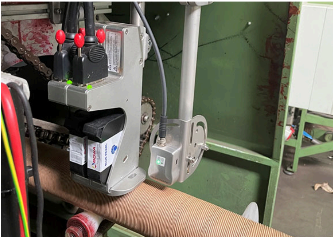
speedMATE® zur Ansteuerung eines Inkjets für die Bedruckung eines Rohres
