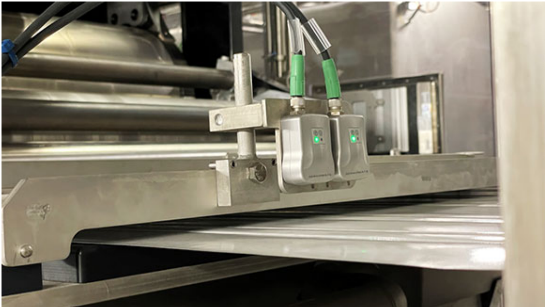
Zwei speedMATE® zur parallelen Ansteuerung zweier Inkjets
