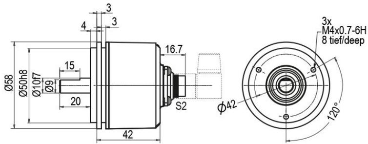
Alle Abmessungen in mm / All dimensions in mm
