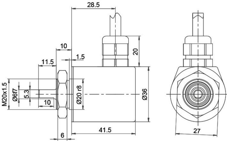
Alle Abmessungen in mm / All dimensions in mm
