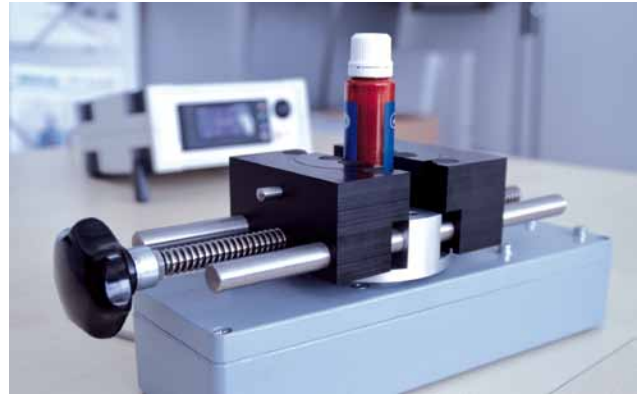
Abbildung WP1602_2: Damit diese Flaschen dicht und trotzdem leicht zu öffnen sind, verwendet der Hersteller für das richtige Drehmoment Messtechnik von INDUK.
